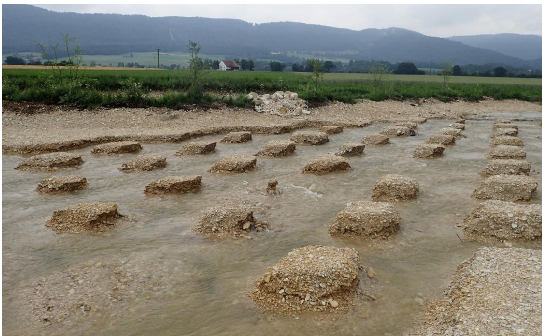
Fig. 12 : érosion des losanges lors de la crue morphogène du 13 juin 2018
